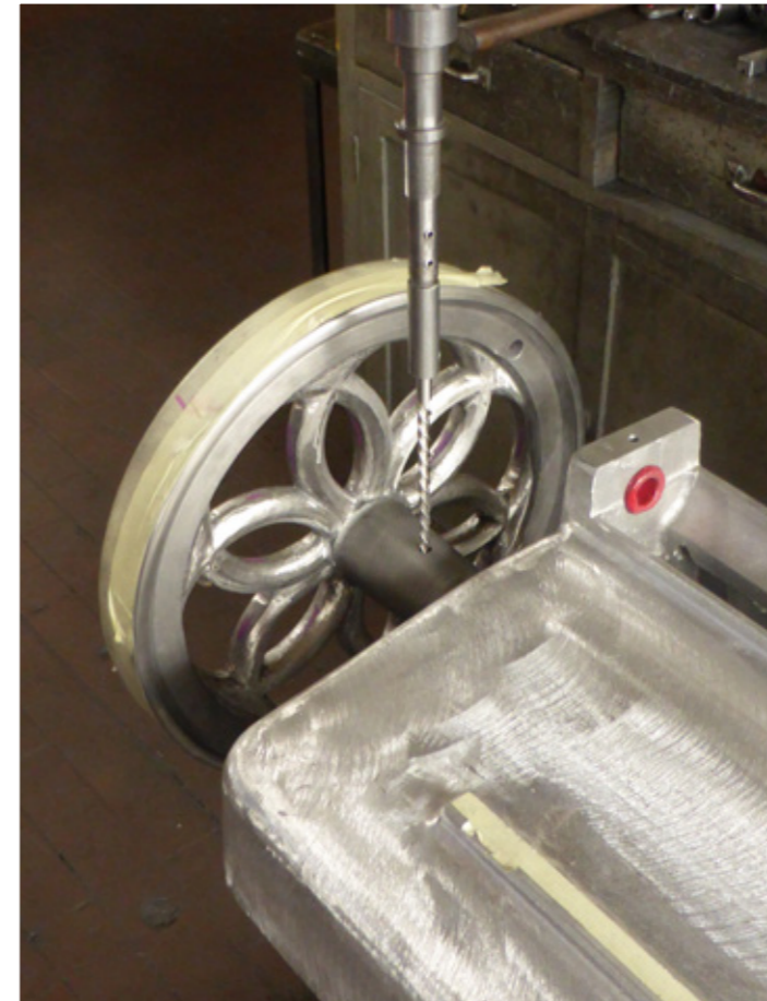
perçage conique du volant et de l'axe
