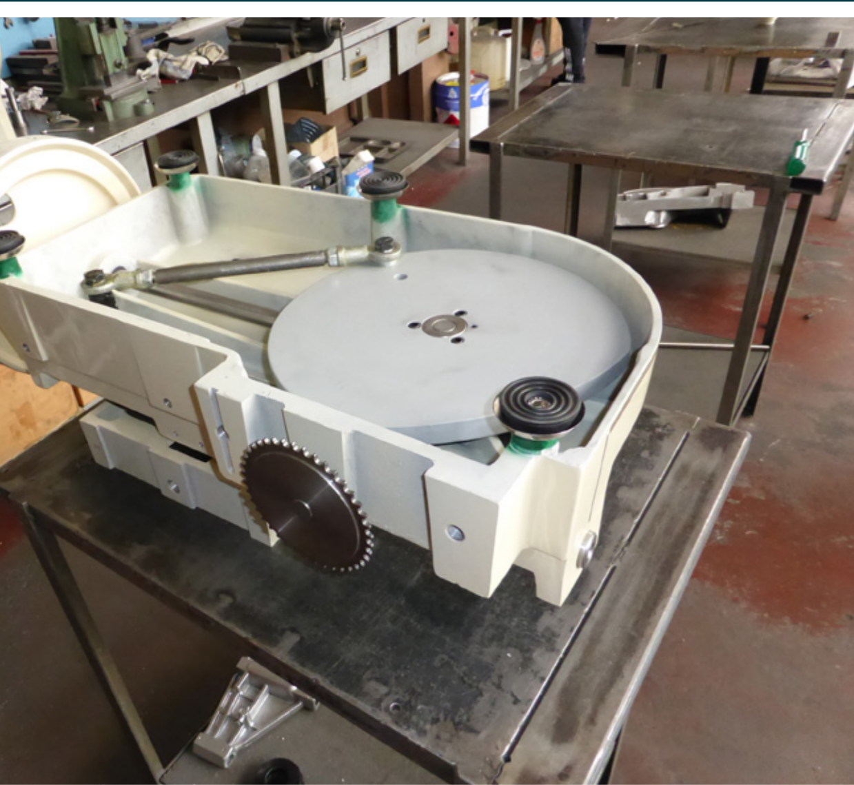
montage de la bielette et des pignons coniques. Vue de la roue fonte «dite de renvoi de force» Elle transforme le mouvement circulaire du volant en mouvement horizontal du chariot.
