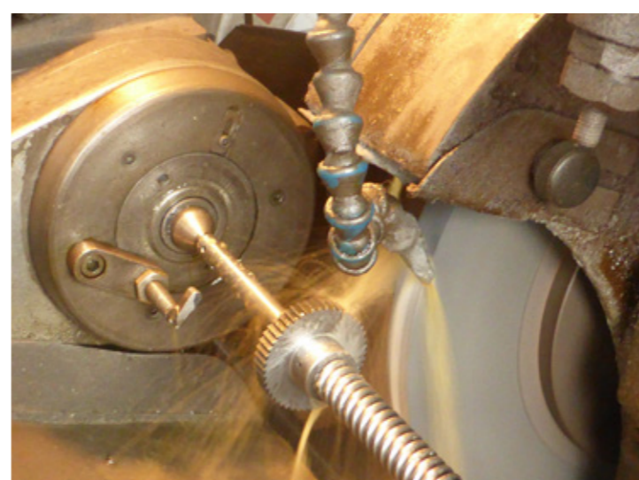
rectification de la roue de crabotage
