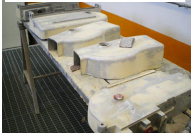
préparation des batis, ébarbage, masticage et polissage
