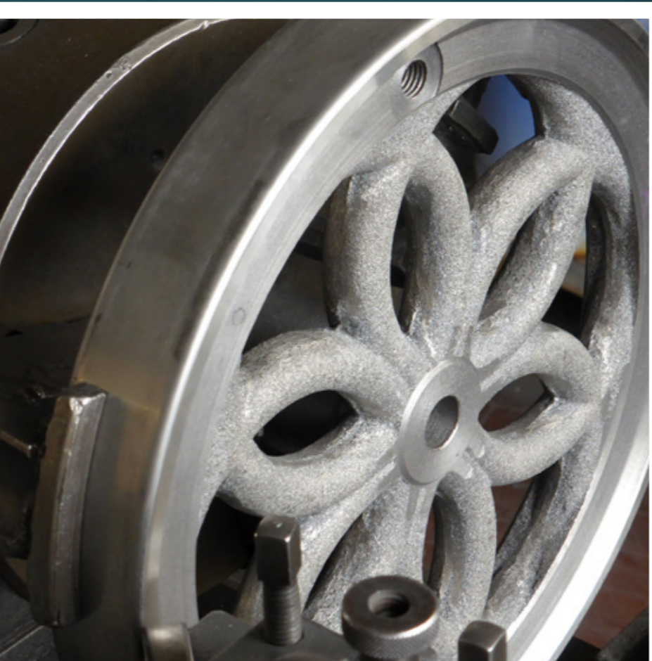
mise en place du cerclage inox sur la bordure du volant par «Repoussage».
